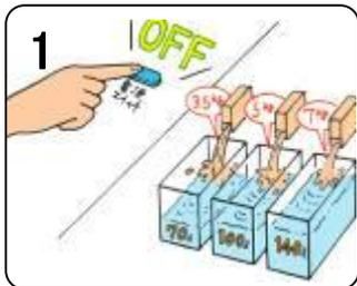
1 供給装置のスイッチをOFFにし、タンクに新しく湯を入れ、SR-20 5%溶液をつくります。
