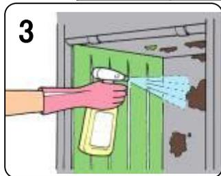
3 スケール汚れのひどい所、洗浄液のあたらないところには原液を直接スプレーします。
