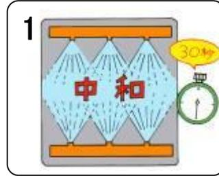
1 中和剤SRをSR-20の溶液に入れ中和溶液をつくり、洗浄機を運転し、30秒間循環運転してから排水します。
