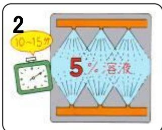
2 洗浄機を運転し、10～15分間循環洗浄します。
