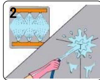
2 洗浄タンクに再度給湯し、洗浄機を運転し、よく洗います。洗浄液のあたらないところはホースでよくすすぎます。
